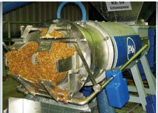
PSS – Behandlung von Prozessabwasser PSS – Treatment of process waste water
