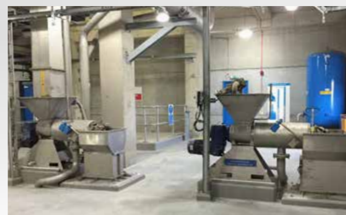
PSS – Separación de desechos finos de la preparación de pasta / PSS – Separação de rejeitos finos para preparação da pasta
