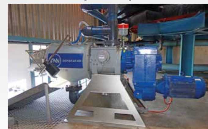
PSS – Separación de agua blanca en combinación con una estación de flotación / PSS – Separação de água branca em combinação com uma estação de flotação
