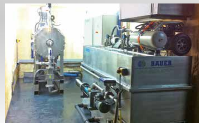
SPS – Separador prensor de lodos con estación de floculación / SPS – Prensa de lamas com estação floculante
